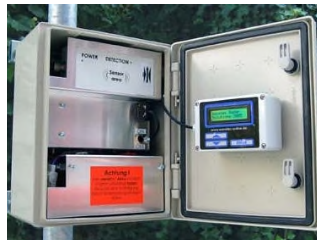
Figura 3.2 – Strumentazione radar Wavetech
