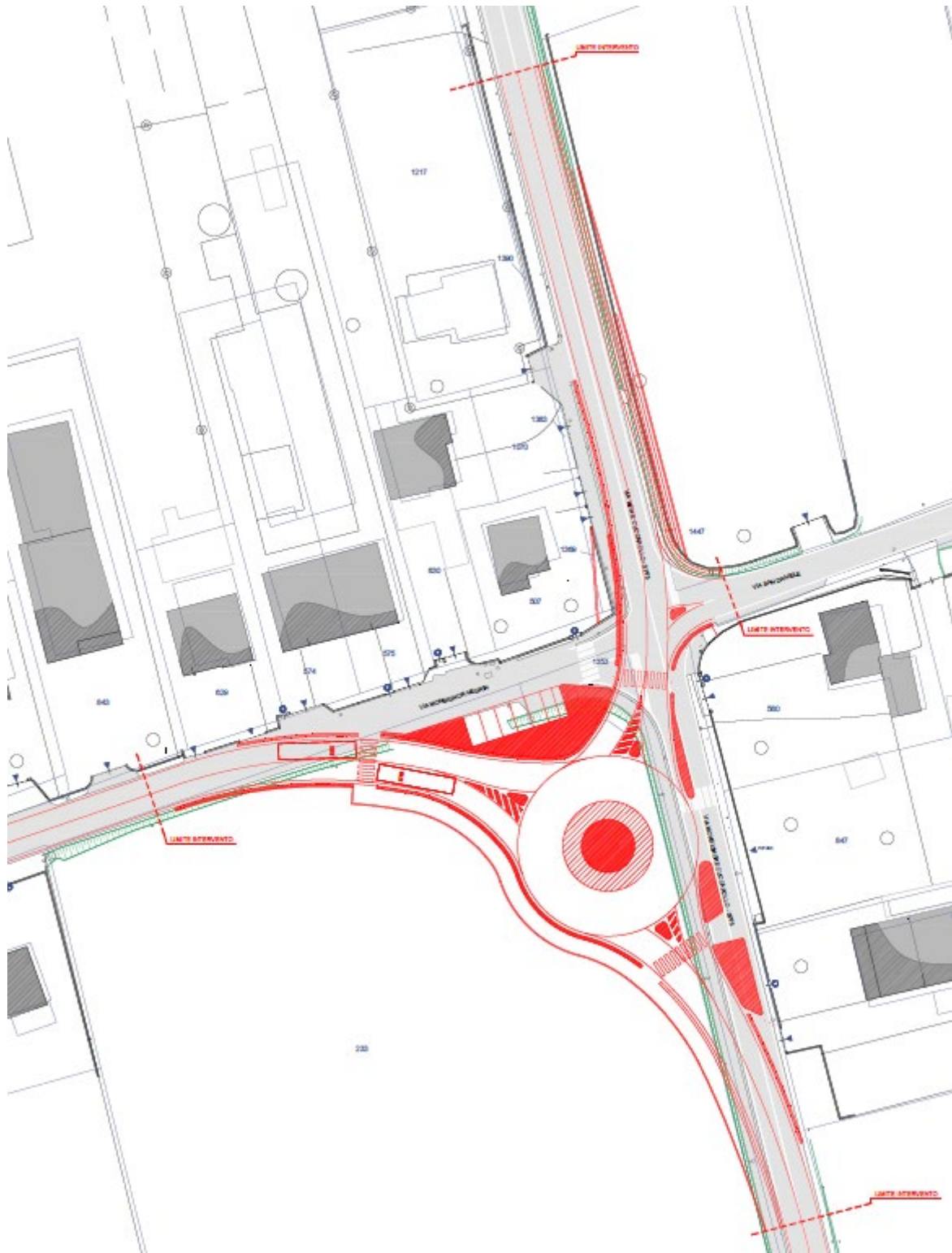
2.1 Sovrapposizione progetto e rilievo stato di fatto
