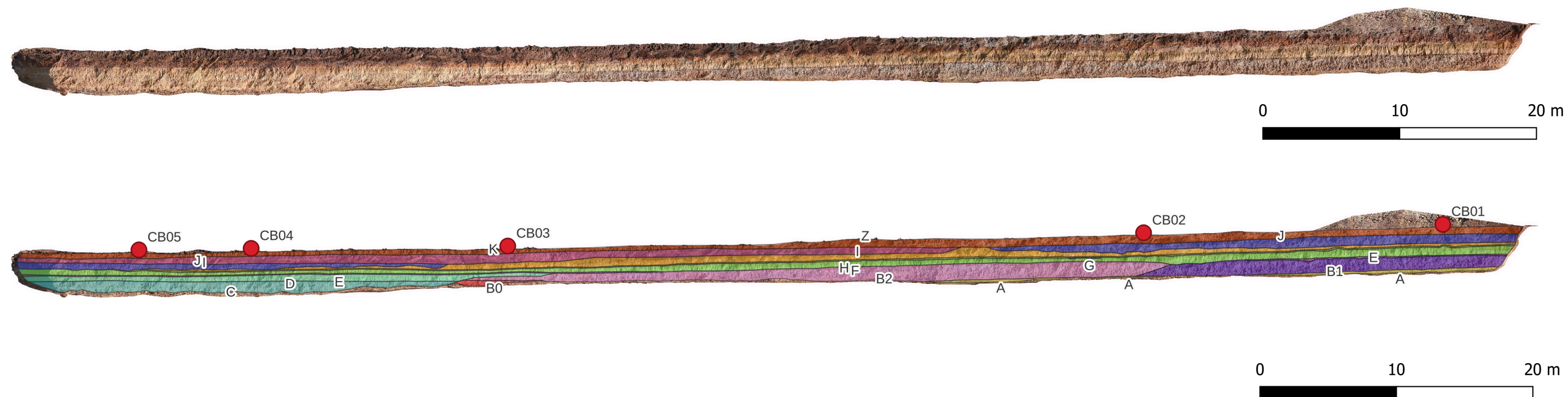
FIGURA 13 - ORTOFOTO DELLA PARETE OCCIDENTALE DELLA TRINCEA SZ01 CON RELATIVA INTERPRETAZIONE DELLE VARIE UNITÀ SEDIMENTARIE. I PUNTI ROSSI INDICANO I PUNTI DOVE SONO STATI MISURATI I LOG STRATIGRAFICI.
