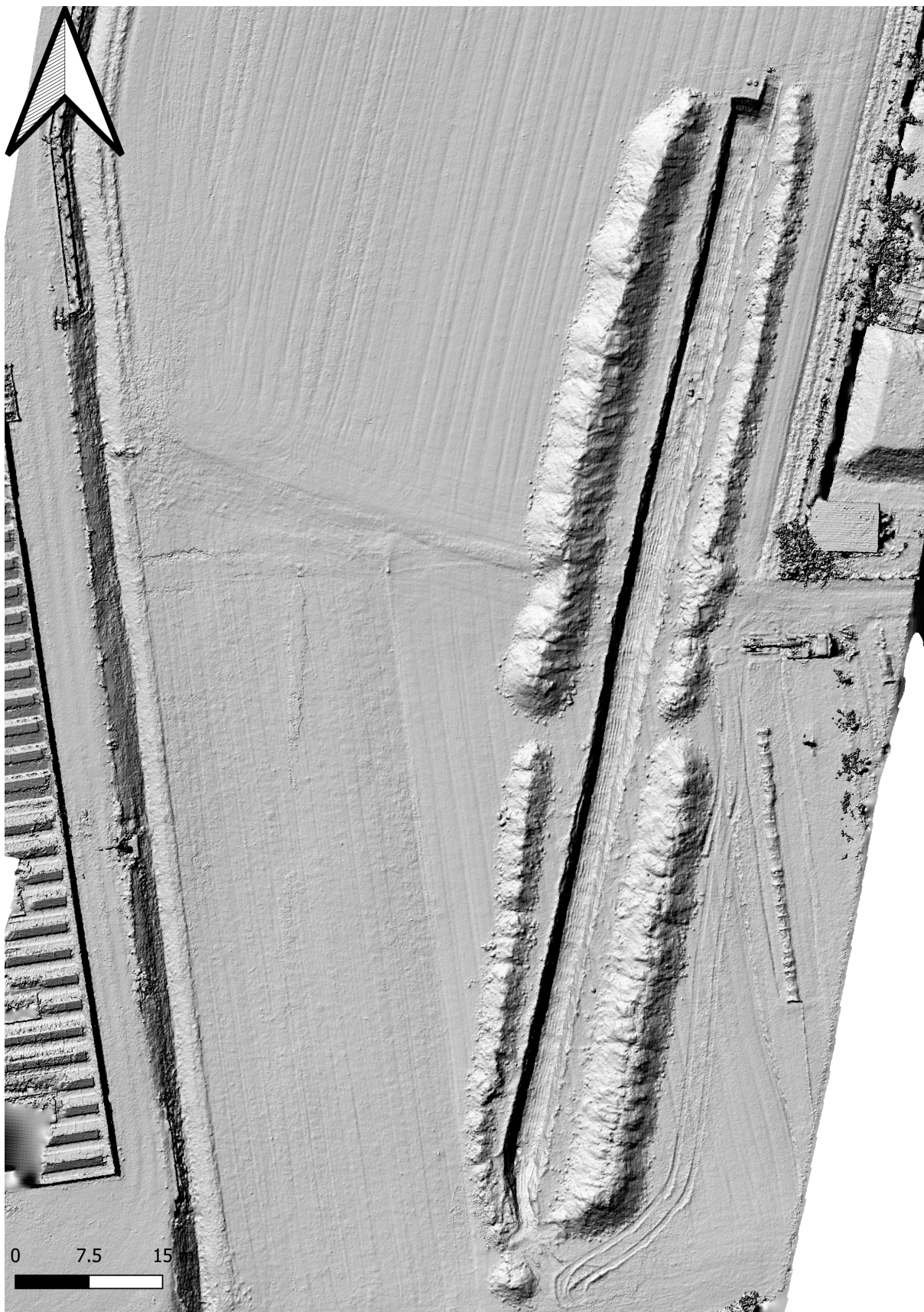
FIGURA 12 – IMMAGINE IN SHADED RELIEF DEL MODELLO DIGITALE DEL TERRENO DERIVATO DA FOTOGRAMMETRIA DA DRONE. L'ANOMALIA MORFOLOGICA CHE SEMBRA DIVIDERE A METÀ LA TRINCEA È DI ORIGINE ANTROPICA
