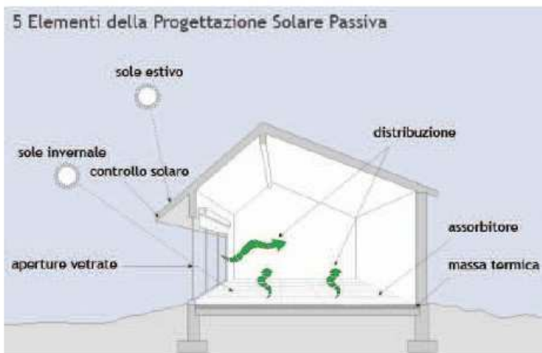
Elementi della progettazione solare passiva
